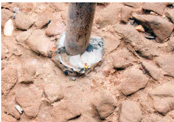
Detall dels punts de control utilitzats com referència durant la sessió de fotogrametria.
